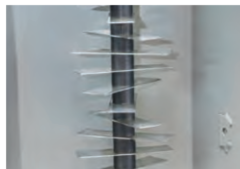
Kugelgelagerte Vertikutierwelle mit gehärteten Doppelstahlklingen
