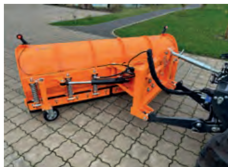
Federklappen als Überfahrerschutz, höhenverstellbare Stützräder
