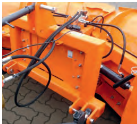
3-Punkt-Aufnahme Kat. I/II, Betrieb mit nur einem dw. Steuerventil
