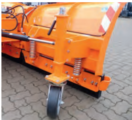
Federklappen als Überfahrtschutz, 50 mm Gummileiste, Anfahrtschutz und höhenverstellbare Stützräder
