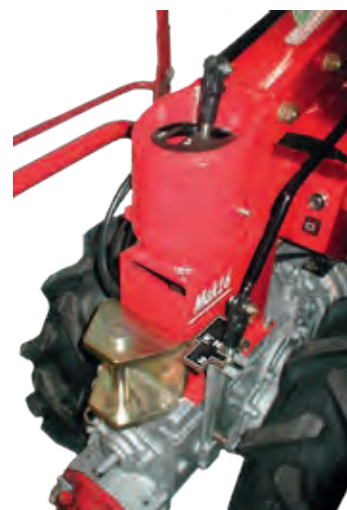
Schaltkulis, Anhängerkupplung + Zapfwelleneinstellung MAK 17
