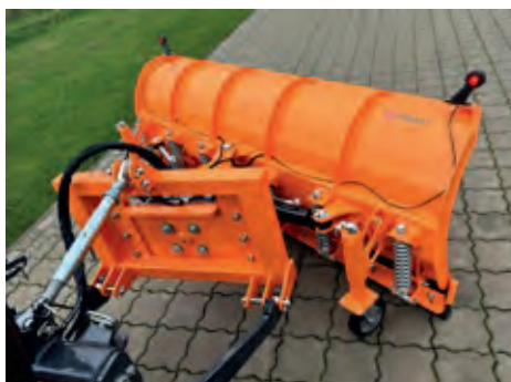
Niveaue Ausgleich, seitlicher Anfahrerschutz
