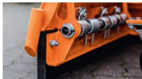
Federklappenelemente mit Gummileiste
