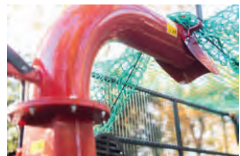
Schwenkbarer Auswurfkanal und verstellbare Auswurfklappe
