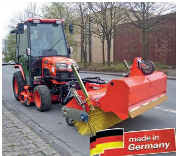
Abstellstütze und stufenlos höhenverstellbare Kehrwalze
