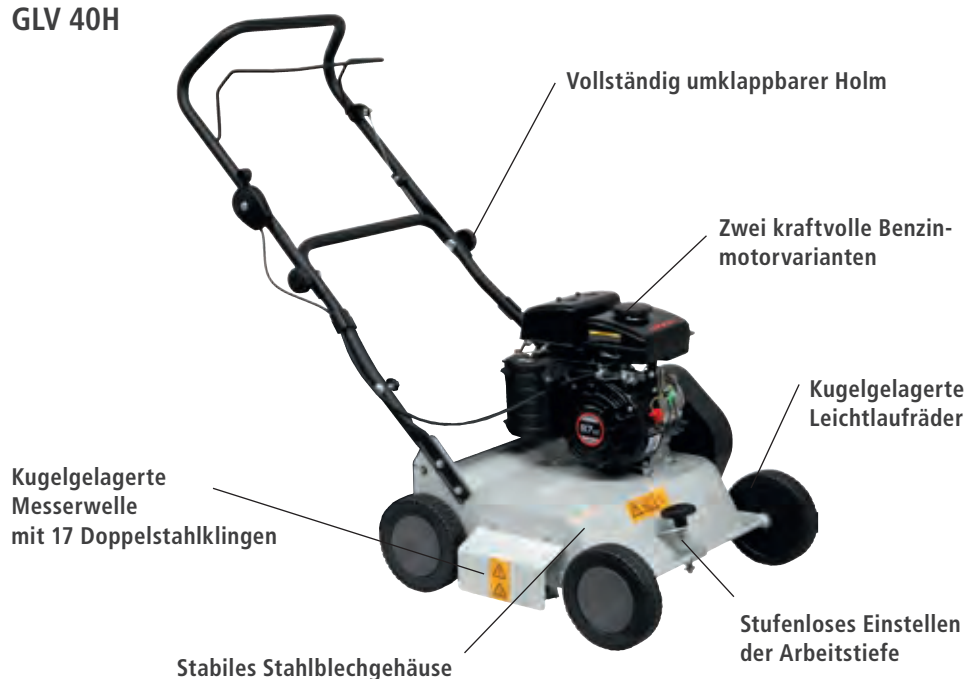
Kugelgelagerte Vertikutierwelle mit gehärteten Doppelstahlklingen
