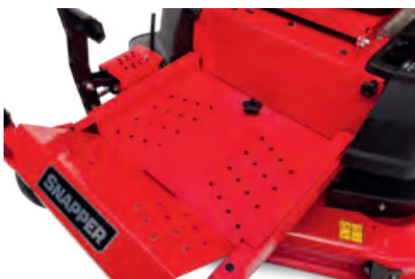
Abnehmbare Bodenplatte für einfachen Wartungszugang
