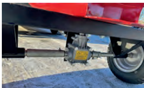
Verstärktes Metallgetriebe mit zuschaltbarem Freilauf für Überführungsfahrten
