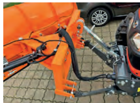
hydr. Seitenverstellung mit 2 Zylindern, 3-Punkt-Aufnahme Kat. I / II
