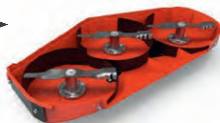
Fertig ausgerüstetes Mähdeck*
