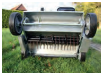
Am Fliehkraftsystem aufgehängte, gehärtete 3mm Vertikutiermesser
