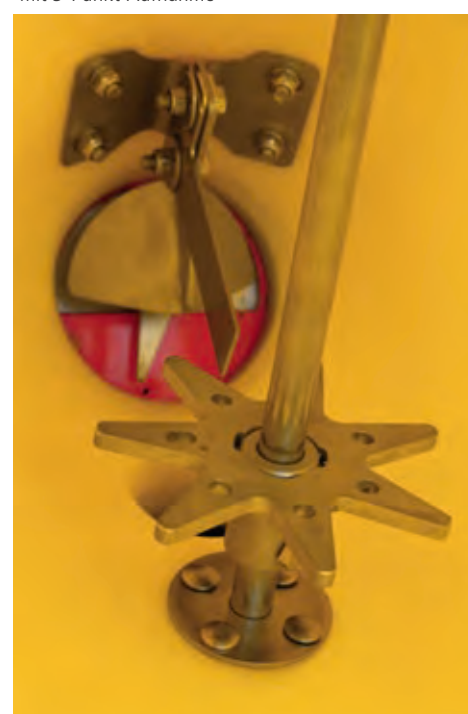
zusätzliches Rührwerk gegen Brückenbildung
