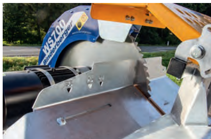
Wippe mit Schutzkäfig und eingelassenen Längensmarkierungen
