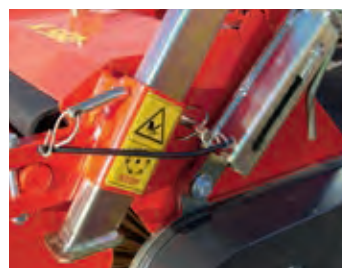
Abstellstütze und stufenlos höhenverstellbare Kehrwalze
